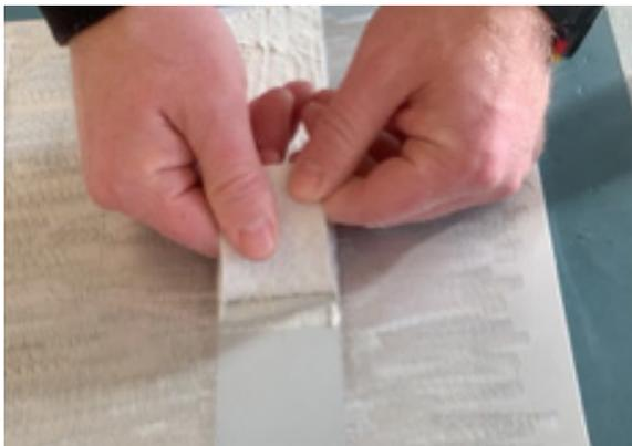
Abb. 3: Schälzugprüfung von Hand, bei FLK mit einem 50 mm x 100 mm Prüfstreifen
